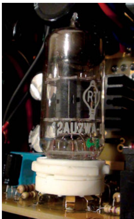
Ecco il doppio triodo 12AU7WA che è un esemplare NOS (New Old Stock) prodotto dalla francese La Radiotechnique (RT).
